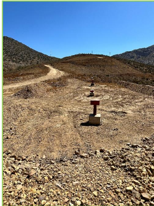
Fotografía 54: Muro Poniente — Eje del muro. Sondajes para Piezómetros de Cuerda Vibrante, vista hacia el sur.
