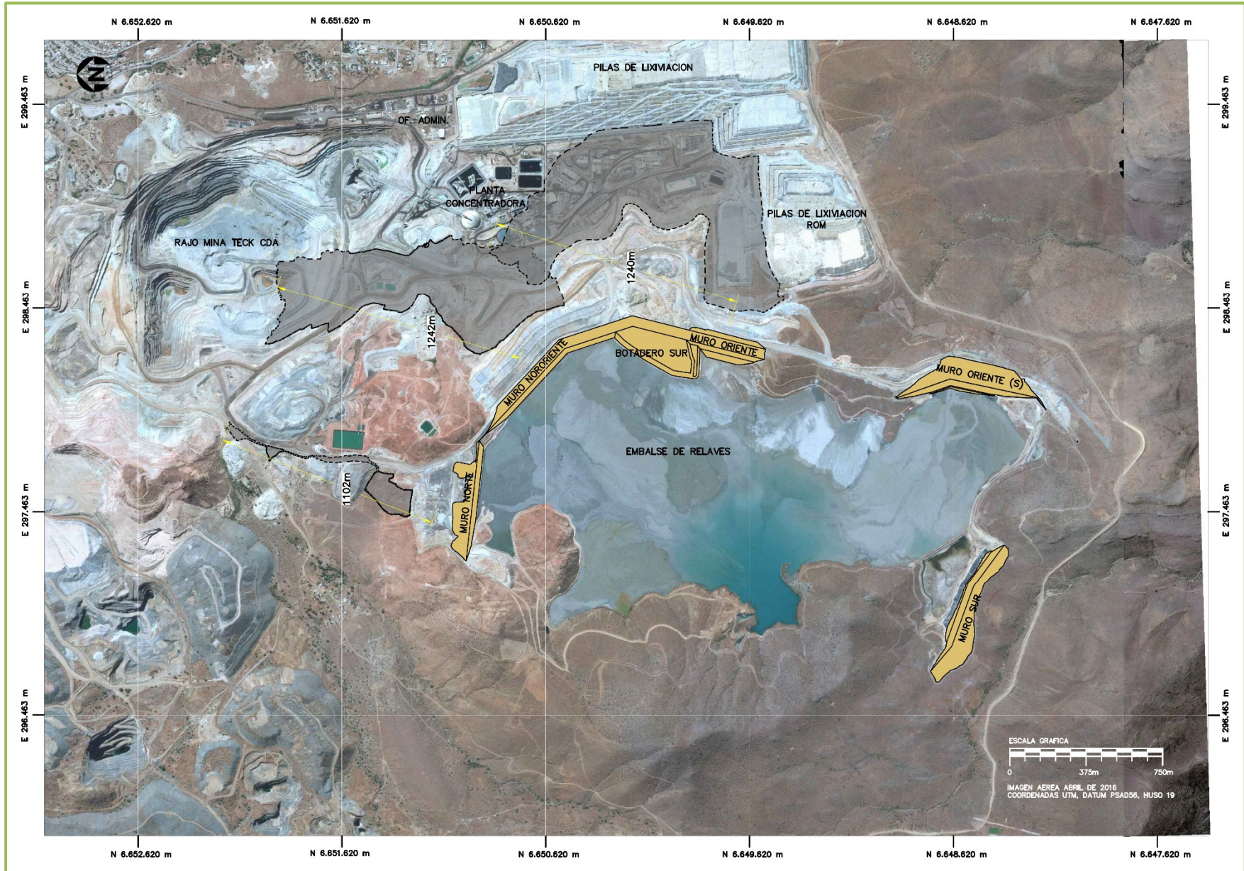
Figura 8-9: Superficie afectada por ruptura de los muros Etapa 3, 2017.03.14 (ref. estudio de Distancia Peligrosa, Wood)
