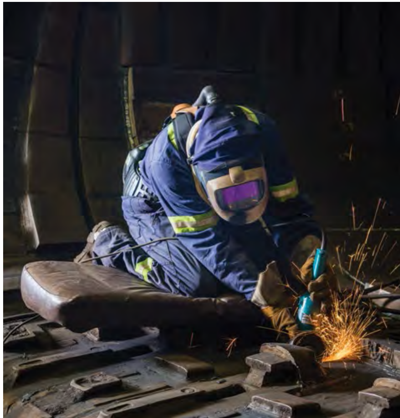
Foto superior: el soldador Pete Kliment repara la cuchara de una pala mecánica en las operaciones Fording River en C. B., Canadá
