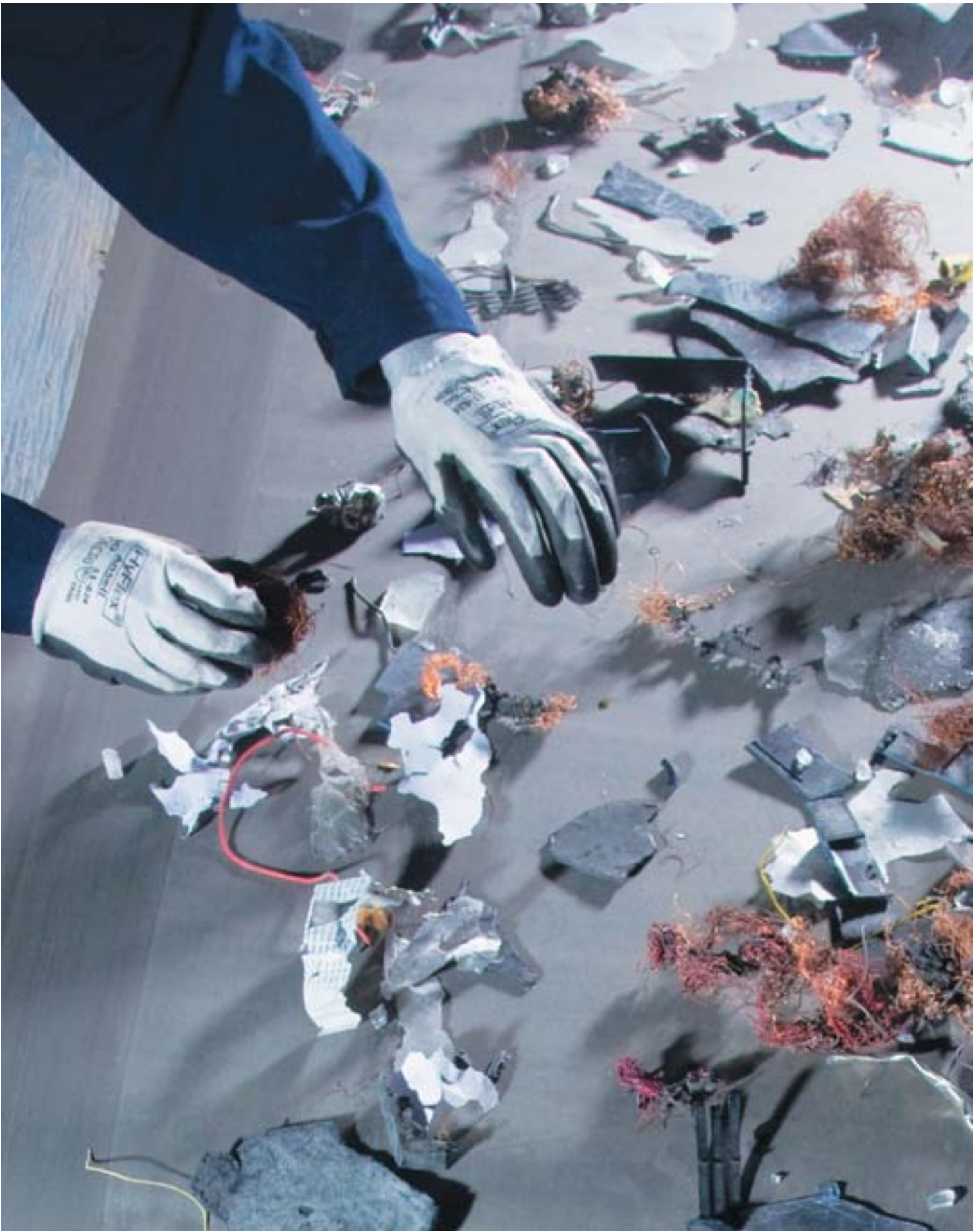
Los desechos electrónicos se clasifican en una cinta transportadora antes del reciclaje en las operaciones Trail, Columbia Británica.
